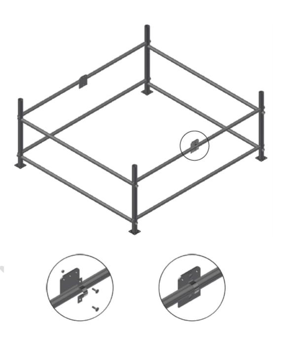
Bügelplatte mit Halbschellen in der Mitte vom Rohr lang montieren.
