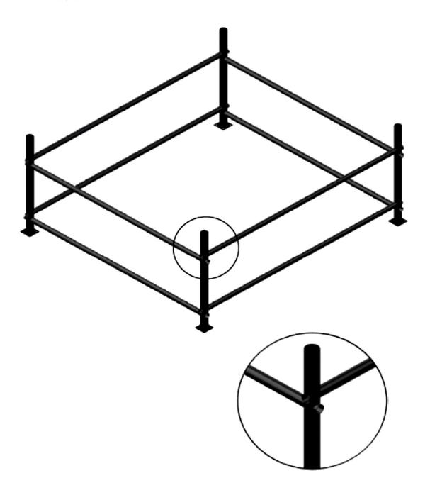
• Rohr lang und Rohr kurz in die Bohrungen der Eckpfosten stecken.
