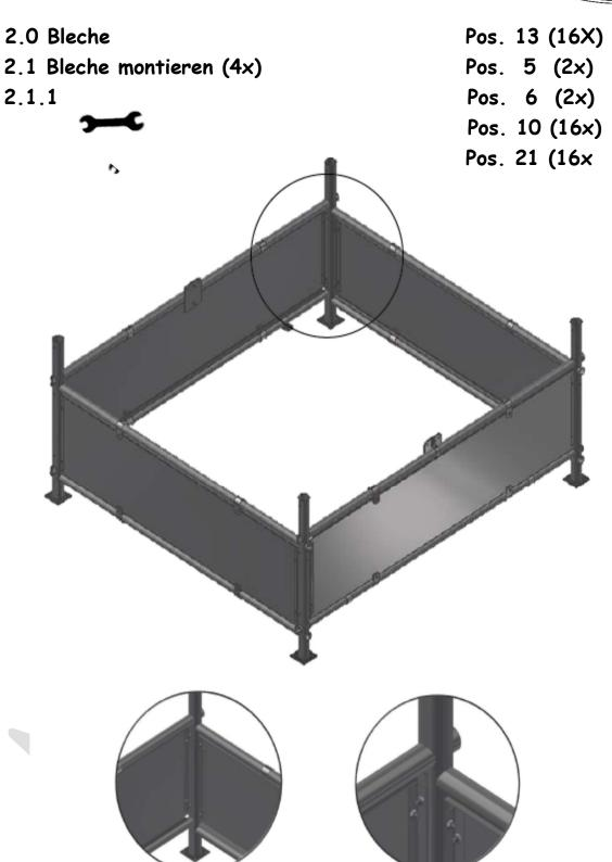
• Seitenbleche an die Winkel der Eckpfosten schrauben, mit je einer U-Scheibe von außen.
